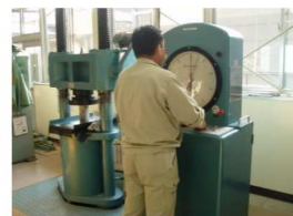
<コンクリート圧縮試験>
